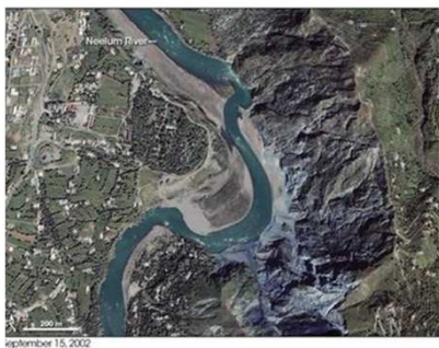
Glissement de terrain Du à la liquéfaction d'un sol (Pakistan)
