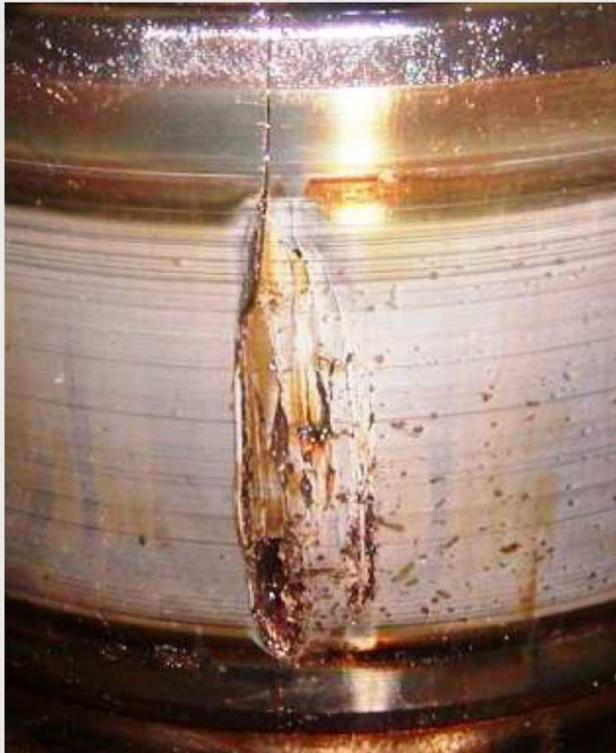
Bague intérieure du roulement supérieur de l'arbre GV fissurée
