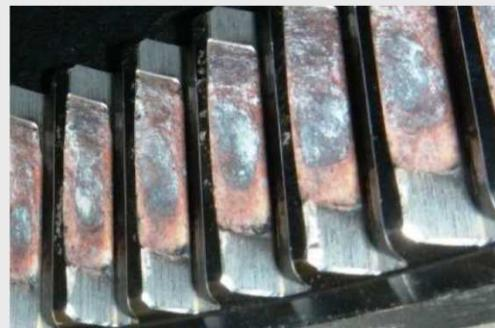
A noter aussi la présence d'une usure importante sur l'accouplement flexident qui aurait pu être aussi à l'origine d'une typologie de chocs à la fréquence de rotation.
