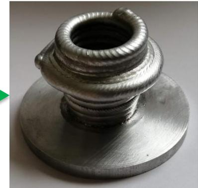
**Brut réalisé par fabrication additive**
