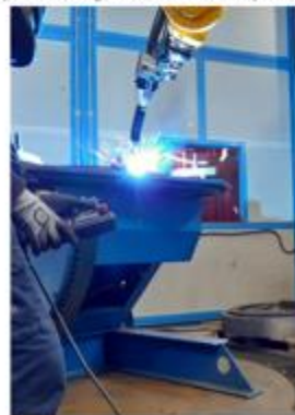
Etape 3 : soudage robotisée WAAM (CMT Twin)
