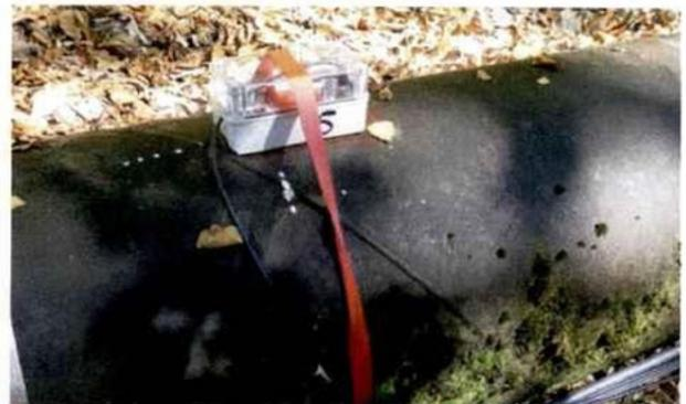
▲ Capteur acoustique installé sur la conduite forcée de la centrale des Moulins à Épierre (Savoie). Photo : Setec/Cetim
