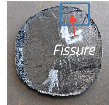
Surface de rupture de la fissure
